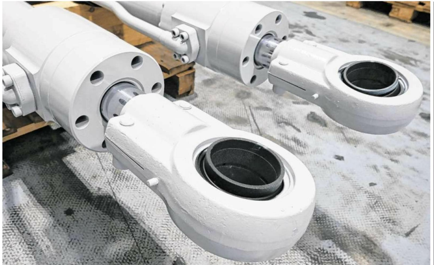
Der Lackier- und Beschichtungsprozess kann beschleunigt werden. Die Firma Aros Hydraulik in Memmingen hat zum Beispiel Hydraulikzylinder nicht mehr eine Stunde lang im Ofen bei 80 Grad trocknen lassen, sondern drei Stunden lang bei Raumtemperatur. Foto: Aros
